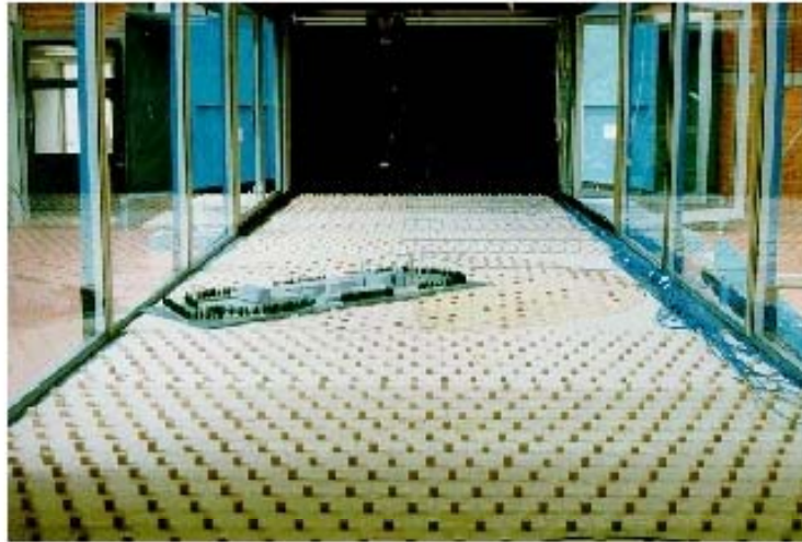
Figura 5.3 - Vista della galleria del vento con set-up per generazione profilo di turbolenza atmosferico
